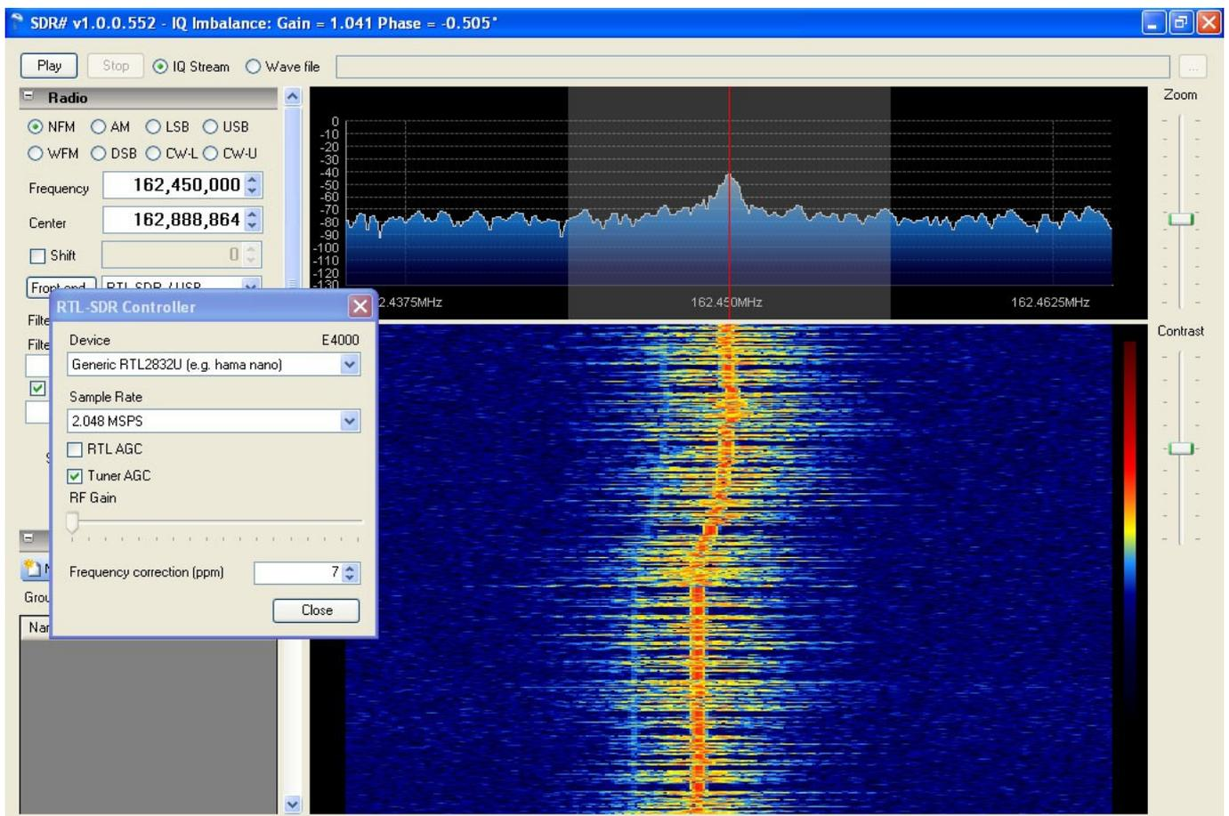
Il centro della portante è al di sotto della posizione prevista sul display, quindi dovremo usare la freccia verso l'alto per aggiungere il moltiplicatore ppm al segnale. Se il centro fosse stato superiore alla posizione prevista (sull'indicatore di sintonia), avremmo usato un adeguamento negativo.
