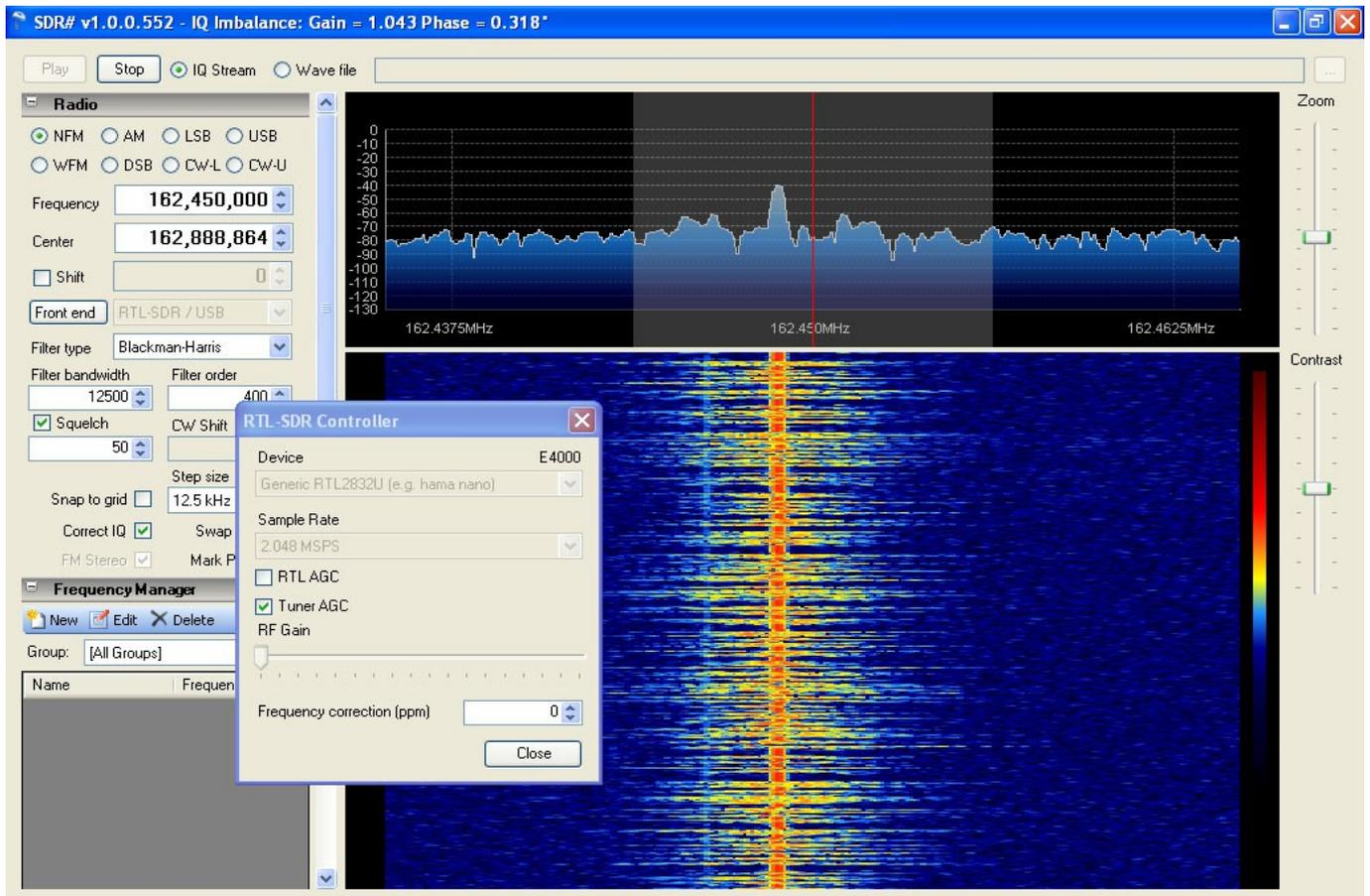
Nel passo successivo utilizziamo le frecce su / giù per regolare la correzione ppm per portare l'indicatore di sintonia al centro della portante. Nel precedente esempio la modalità di ricezione è NFM (FM stretta) e il centro della portante è chiaramente visibile.
