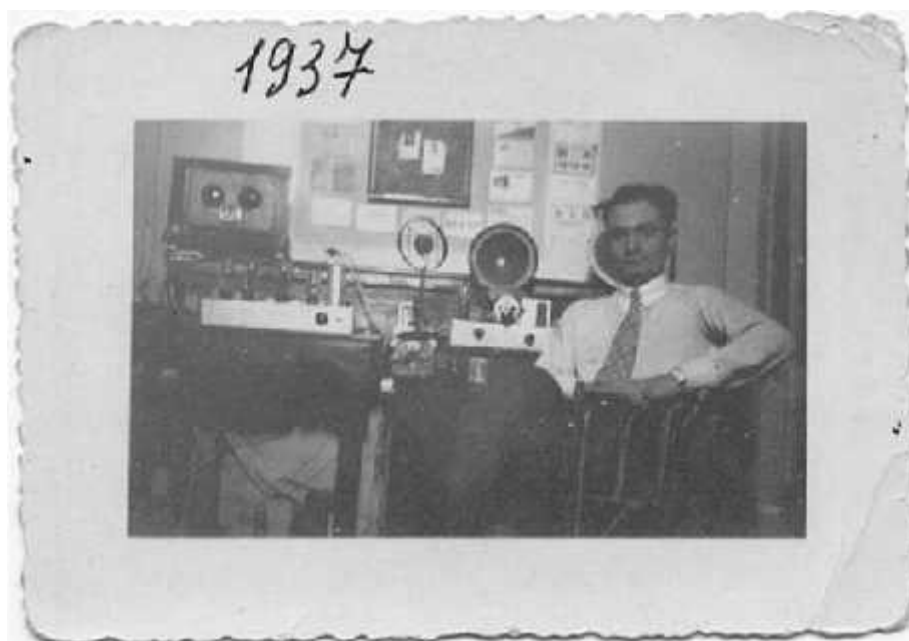
Foto2: 1937 Stazione trasmettente i1FP. In alto a sinistra lo stadio RF xtal 7Mhz, in basso a sinistra lo stadio modulatore AM. Stadio finale RF con valvola "tipo 47", potenza 5w, antenna filare 1/2 .
