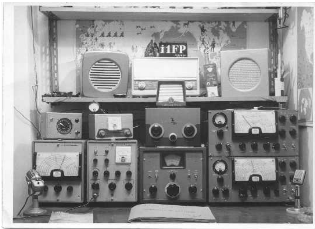
Foto 28: i1FP novembre 1962. Prima stazione SSB. Da Sx: VFO della Miniphase (Glaugo Rustichelli), TX con generazione di SSB a sfasamento. Al Centro: Adattatore ("Slicer") per la ricezione della SSB su RX autocostruito. A DX: Ricevitore e Trasmettitore auto costruiti con componenti Geloso.
