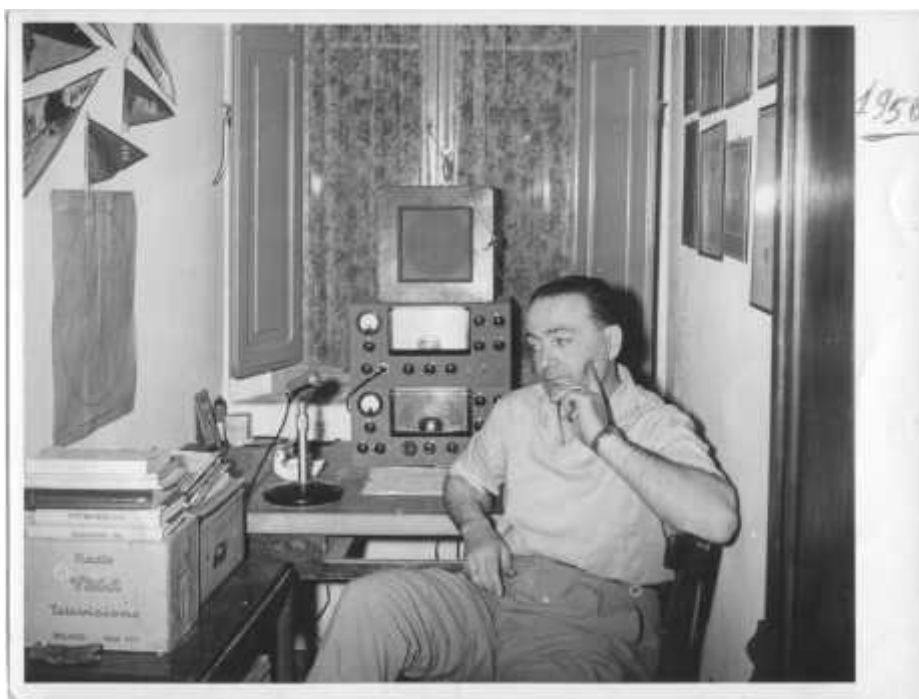
Foto 26: i1FP settembre 1956. Ricevitore e trasmettitore auto- costruiti con componenti della Geloso.
