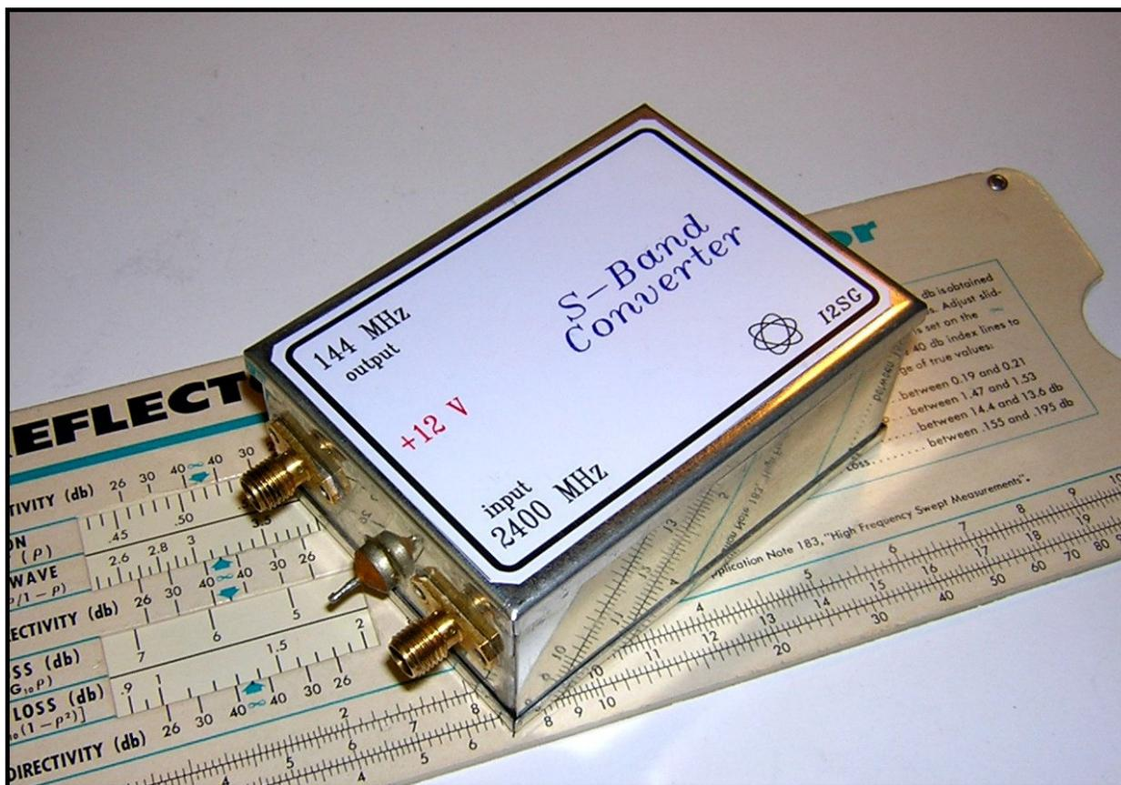
Il convertitore descritto, originalmente sviluppato per il Phase 3-D, è adeguato per la ricezione di OA-51 ed altri satelliti amatoriali con *down-link* nella banda dei 2,4 GHz. Le soluzioni illustrate possono essere applicate in altre realizzazioni in Banda "S" o scalate per frequenze diverse.
