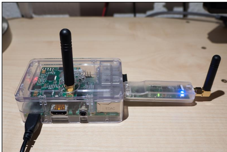
Semplice sistema portatile RaspBerry con modulo WIFI e DV4mini su rete wifi o 3G/4G cellulare
