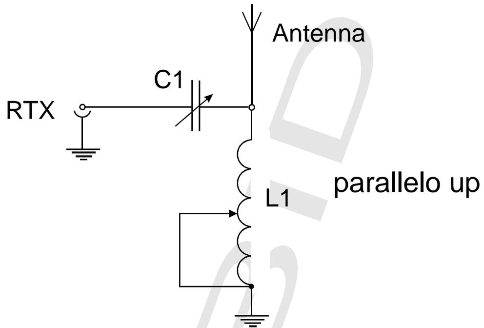
Circuito CL in configurazione Step-Up per fili random ad alta impedenza in questo caso l'antenna è elettricamente a massa.
