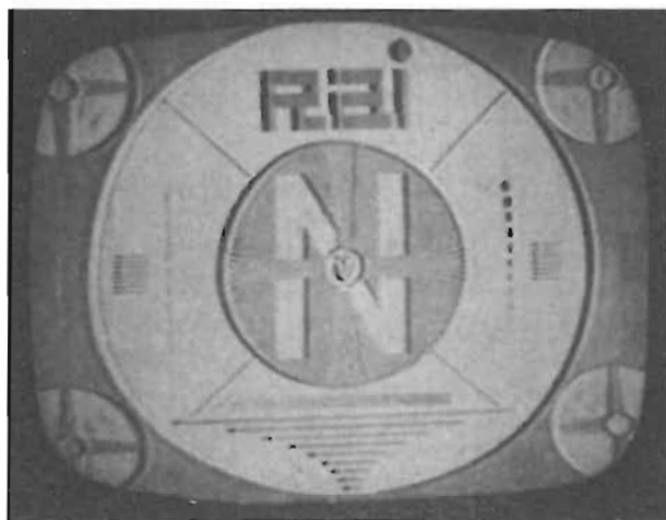
Fig. 4.185. - Immagine poco contrastata, cinescopio esaurito e difetto dovuto alla sovracompensazione dell'amplificatore a VF.
