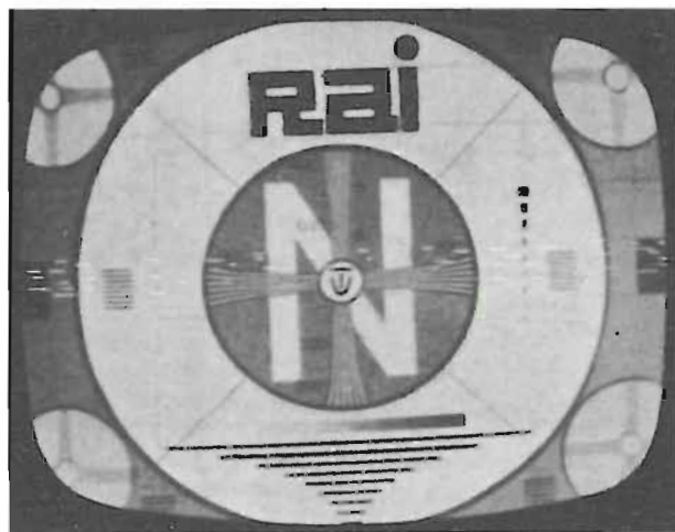
Fig. 4.183. - Scariche che disturbano l'immagine (fra filamento e catodo di una delle valvole accese in serie, nel trasformatore di alimentazione, in una valvola raddrizzatrice o un diodo).
