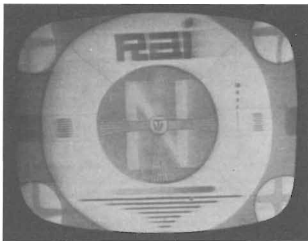
Fig. 4.32. - Immagine prodotta per la resa scarsa alle frequenze basse (distacco del condensatore di accoppiamento al catodo del cinescopio) o per esaurimento del catodo.
