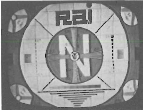
Fig. 4.31. - Immagine del monoscopio prodotta da compensazione inesatta (eccesso di induttanza o interruzione della resistenza di smorzamento in parallelo a una bobina di compensazione).
