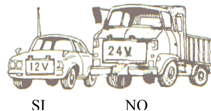
Attenzione alla tensione
